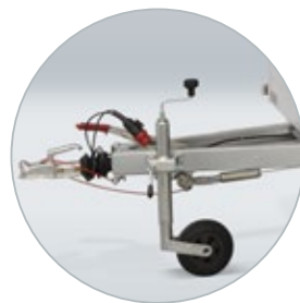
V-dissel uit U-profiel bij breedte 126 cm
